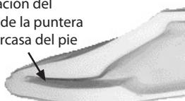
Empuje el muelle de la puntera hacia el portador. Asegúrese de que la media deslizante no se queda atrapada entre el muelle y el portador. Empuje el resorte hacia su emplazamiento en la carcasa.
