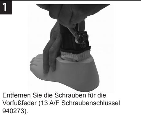
Entfernen Sie die Schrauben für die Vorfußfeder (13 A/F Schraubenschlüssel 940273).
