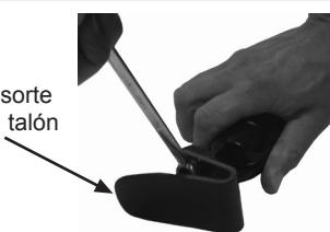
Afloje y retire los tornillos del muelle del talón. Ensamble el nuevo muelle en el portador, use Loctite 243 (926012) y torque hasta los 15 Nm. Use una llave Allen especial 940080, un adaptador de llave de torque 940081 o una llave 13 A/F 940273.
