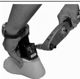
Fije el resorte de la puntera en el portador usando Loctite 243 (926012) sobre los pernos. 1. Para los muelles del tipo 1 al 7 use una llave Allen
