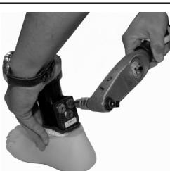
Fixer la lame d'avant pied sur le support en appliquant de la Loctite 243 (926012) sur les vis.
